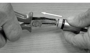
Stator aus dem Motorgehäuse demontieren
